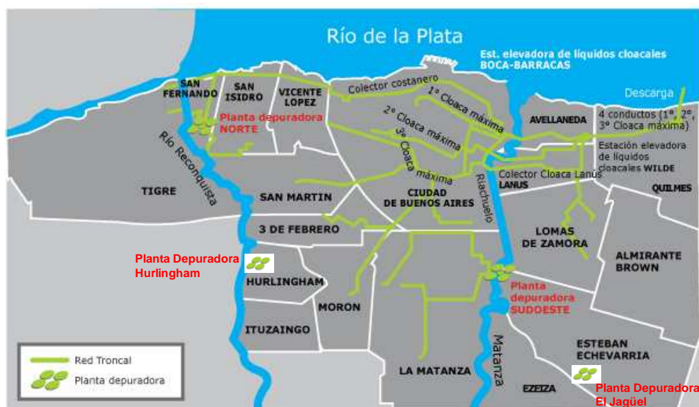
Figura 1: Sistema de Saneamiento Cloacal. Configuración actual
